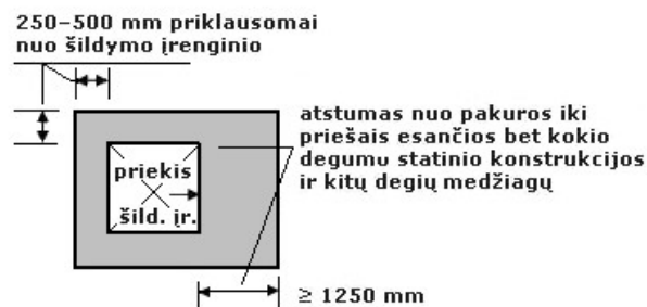
6 pav. Atstumo tarp šildymo įrenginio ir statinio konstrukcijos ir kitų degių medžiagų nustatymo principas
